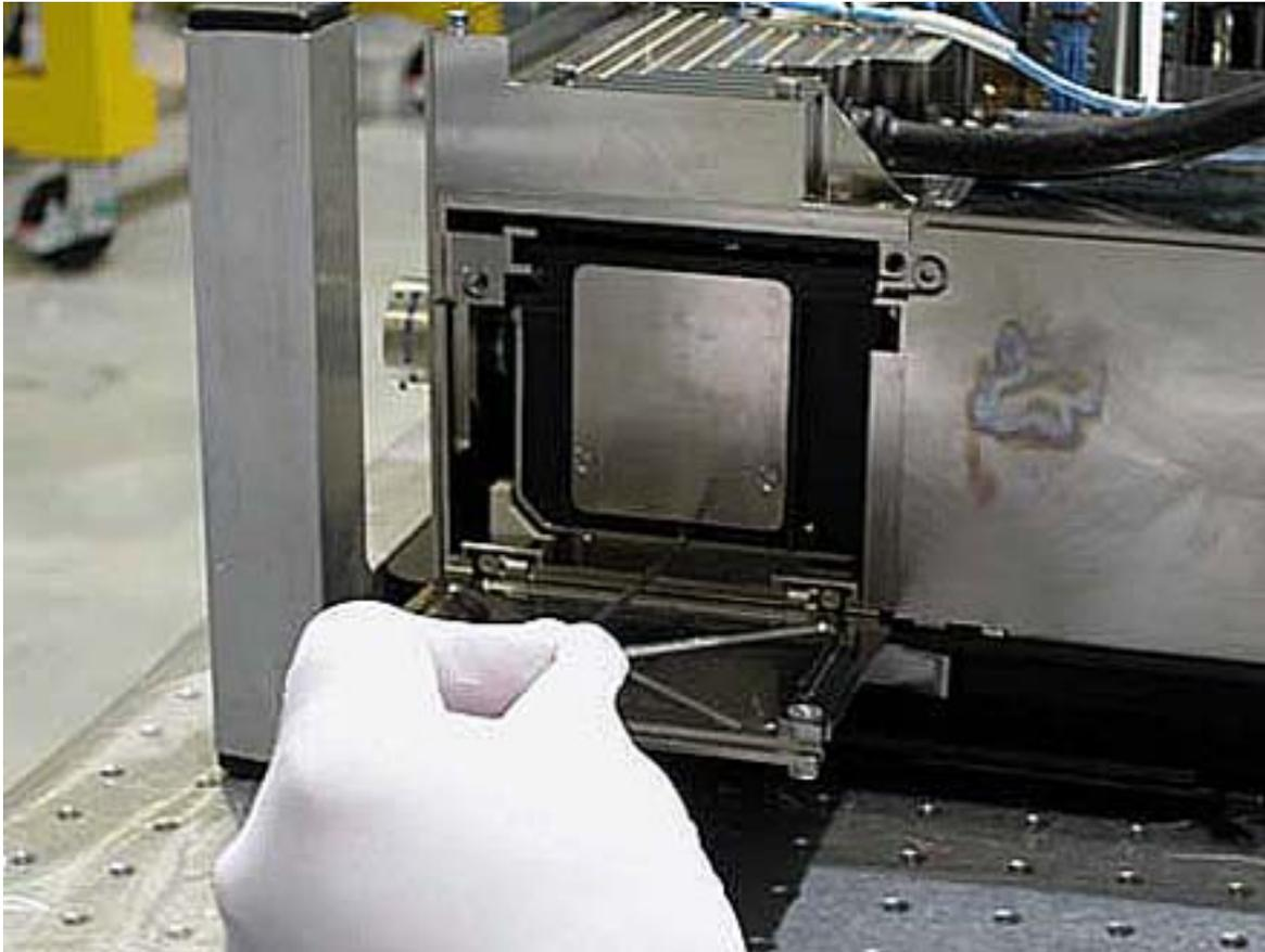
Figure 18. Lamp Fixation
