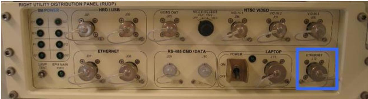
**Figure 4. RIGHT UTILITY DISTRIBUTION PANEL (RUDP) LAPTOP ETHERNET J12**
