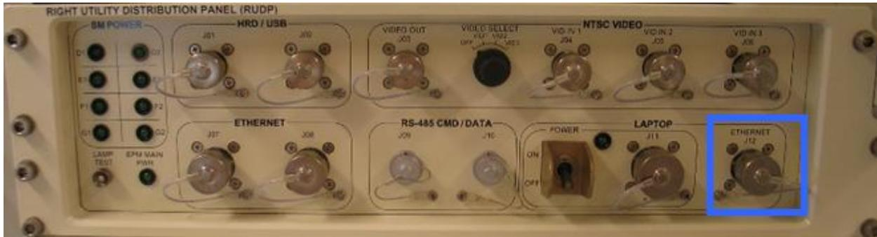
Figure 2. RIGHT UTILITY DISTRIBUTION PANEL (RUDP) LAPTOP ETHERNET J12
