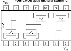
4066 CMOS quad bilateral switch IC
