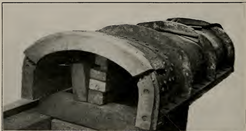
S. S. SANTOS, I. P. VALVE CHEST READY FOR WELDING.
