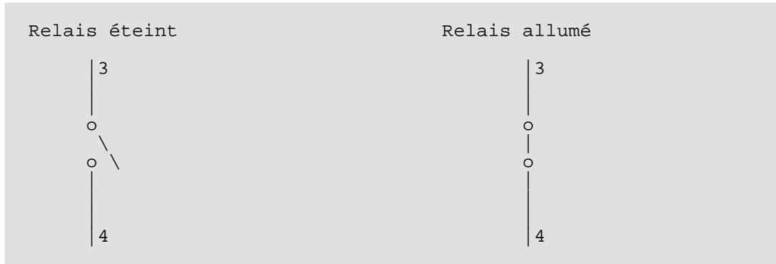
Le schéma suivant montre le fonctionnement d'un relais à 4 bornes.
