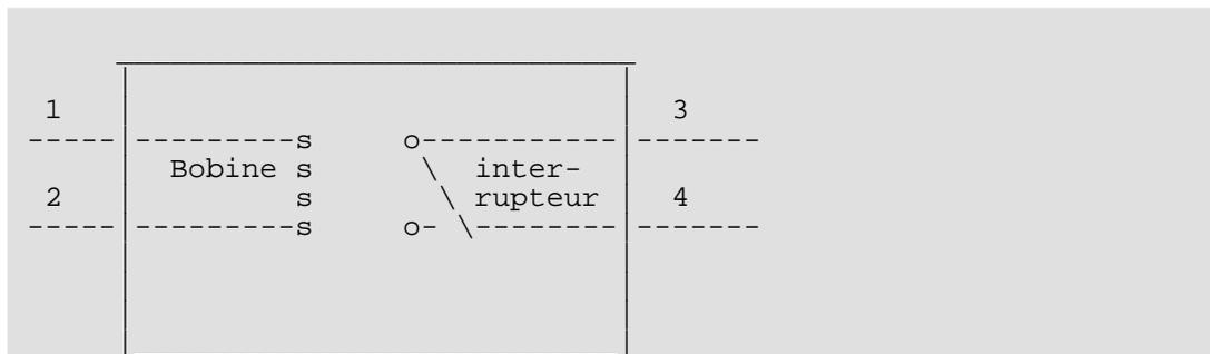
Dans le schéma ci-dessus, les bornes 3 et 4 ne sont pas reliées par défaut. Quand vous envoyez du +12 V entre les bornes 1 et 2, ça déclenchera l'interrupteur, et les broches 3 et 4 seront reliées.
