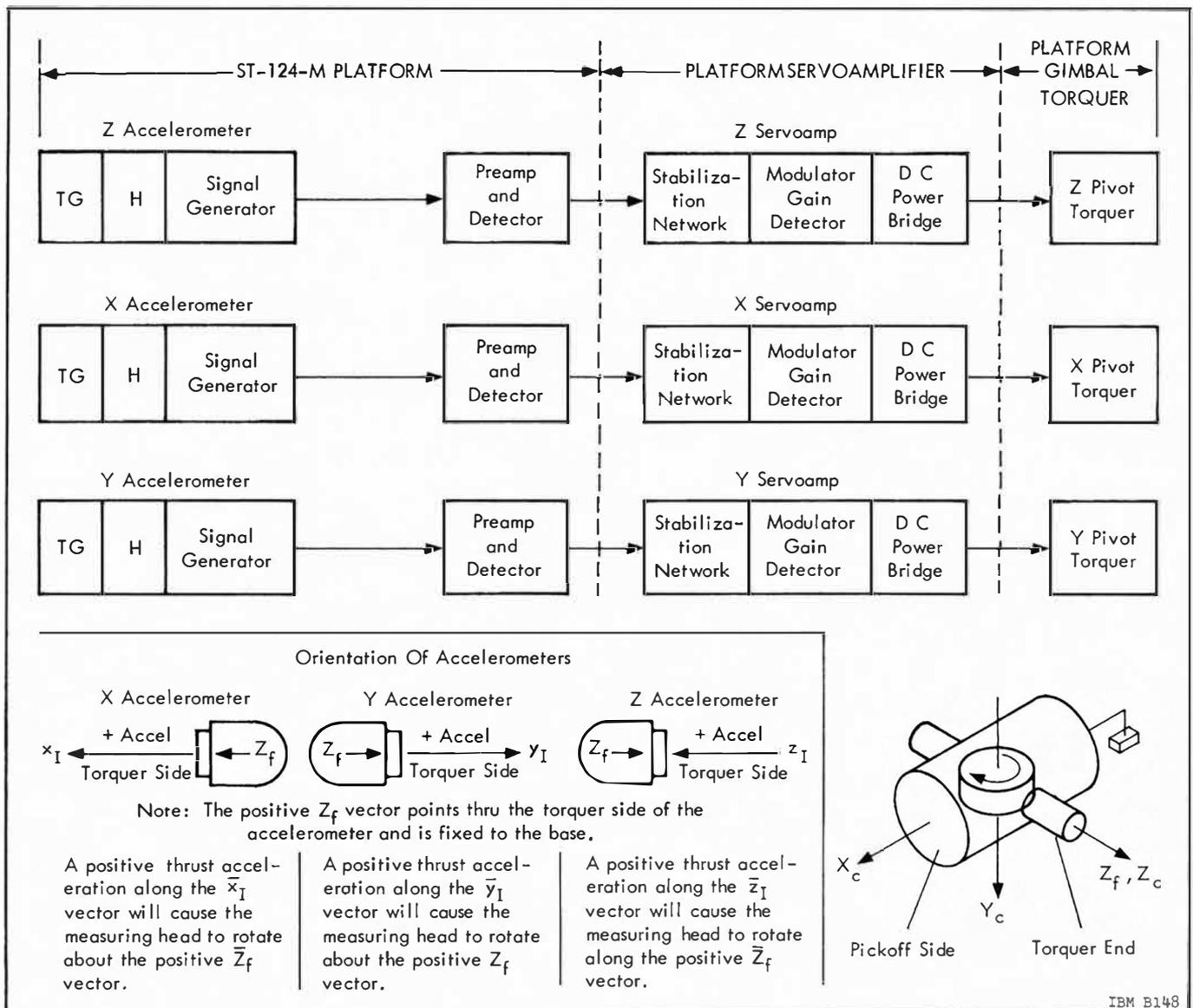
Figure 14. 3-2 Accelerometer Servoloops
